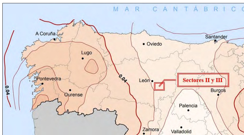
Ilustración 232.- Detalle de peligrosidad sísmica en la ubicación de los sectores II y III.
