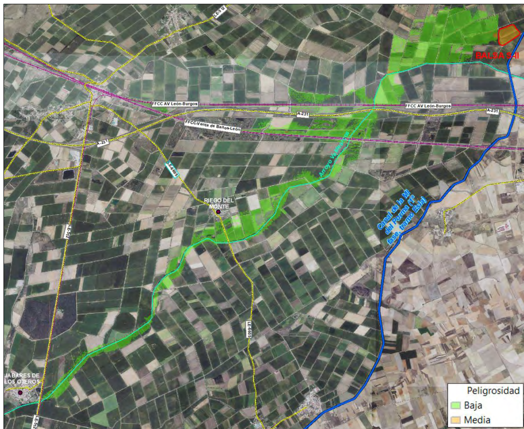
Ilustración 247.- Envolve de peligrosidad rotura balsa sector II.
