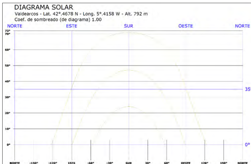
Ilustración 12.- Diagrama solar trayectoria del sol en la zona de instalación de la infraestructura fotovoltaica del sector II.
