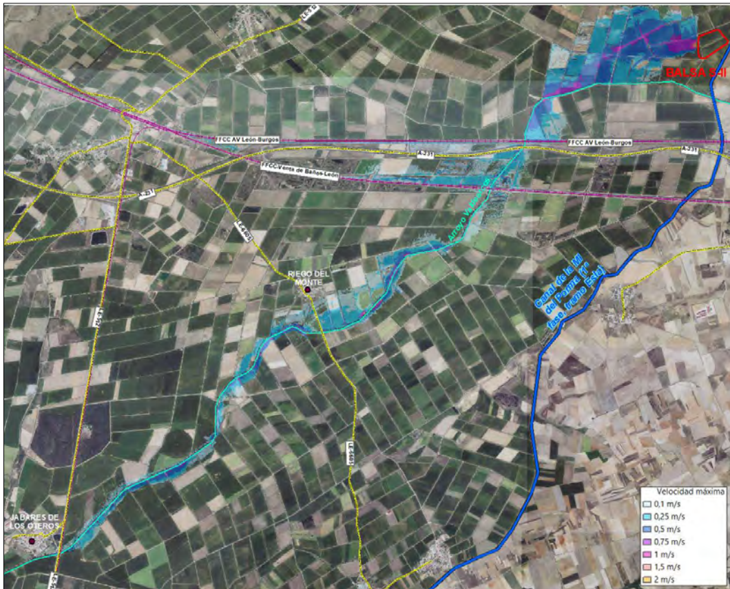
Ilustración 246.- Envolve de velocidad máxima rotura balsa sector II.
