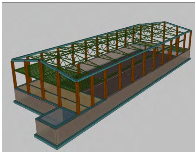
Ilustración 41.- Imagen 3D de la estructura de la nave para la estación de bombeo del sector III.
