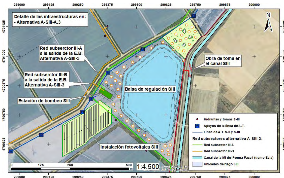
Ilustración 17.- Detalle de la red de los subsectores III-A y III-B a la salida de la misma E.B. del S-III.
