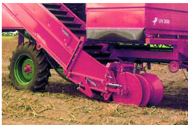
Detalle de la unidad de arranque para una fila con el diábolo de apoyo y los discos laterales, junto con cadena flotante de acompañamiento.
