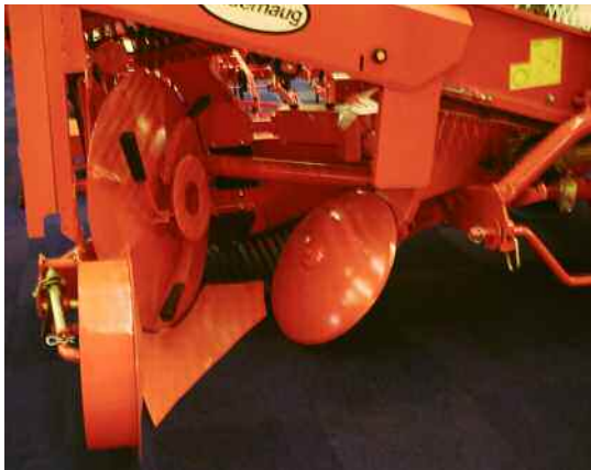
Rotor asociado a la reja para ayudar a la entrada del material y a su separación.
