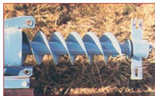
transporte mediante tornillo sinfin
