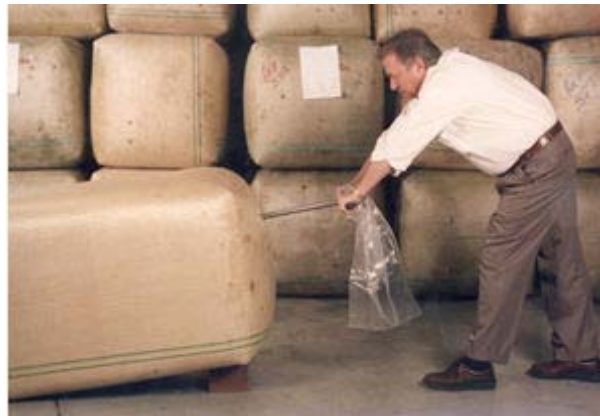
Figura 16.- Equipo completo para la toma de muestras mediante sonda
