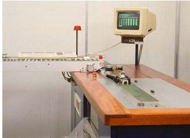
Figura 20.- Aspecto general del ATLAS para la medición de la longitud de fibras
