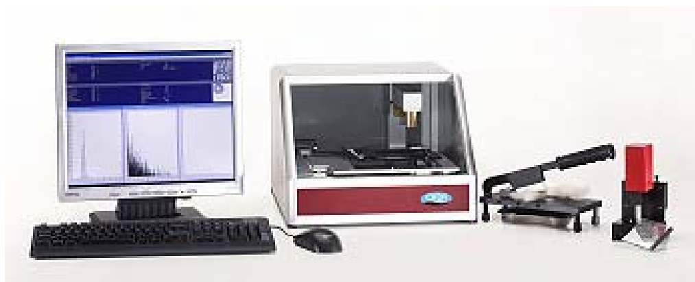
Figura 19.- Equipo OFDA para la medida de la finura, rizado y medulación de las fibras
