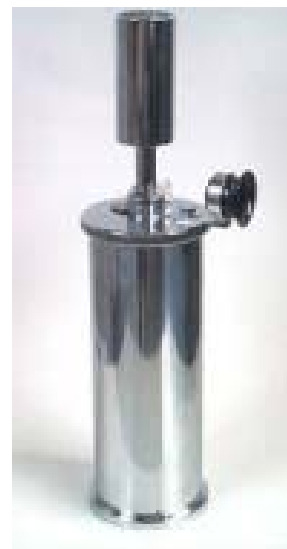
Figura 23.- Bulkometer para la medida de la voluminosidad de las lanas
