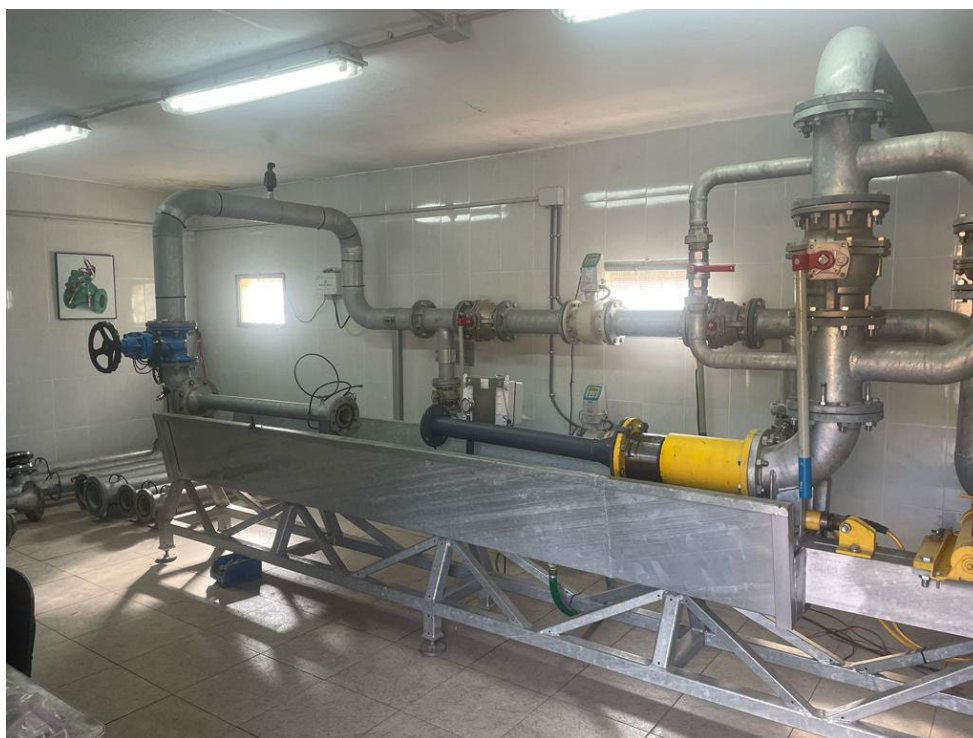
Figura 21. Banco de pruebas para contadores
