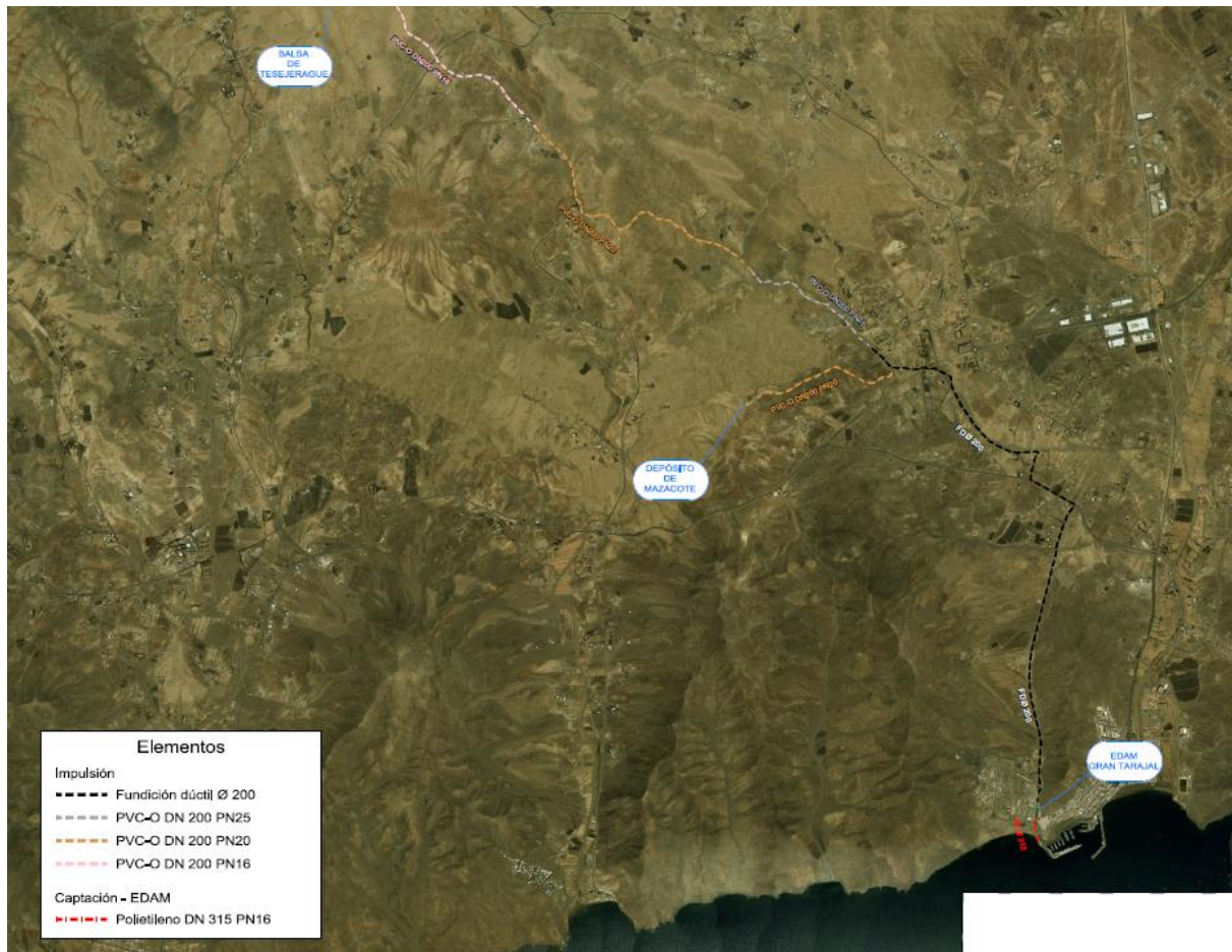
Fig. 8. Planta general impulsión. Materiales.
