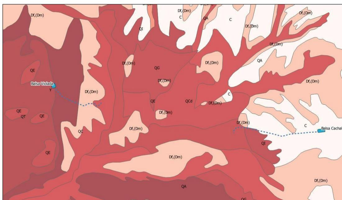
**Figura 3:** Litología de la zona de estudio donde C (Carbonatada), Dm (areniscas), Df (arcillas), QA (aluviales), QI (cantos, arenas y arcillas). Al Oeste (en azul) la nueva balsa de riego "Artaún" y su tubería de conducción y al Este (también en azul) la nueva balsa de riego "Cachal" y su tubería de conducción. **Fuente:** Visor IDEARAGON.
