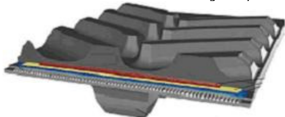
Estructura de la banda de goma y resaltes internos de la banda
