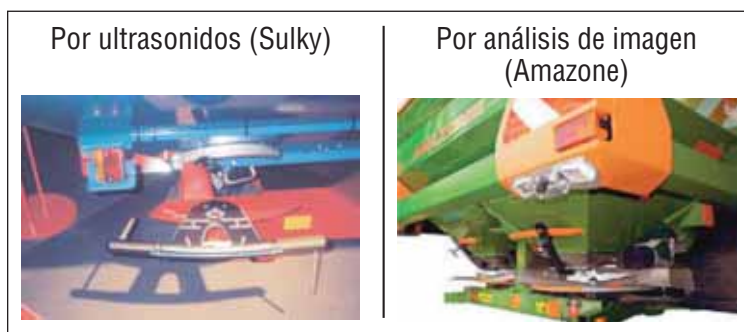
FIGURA 5.- SISTEMAS PARA DETECTAR EL HAZ DE PROYECCIÓN DE FERTILIZANTE GRANULADO
