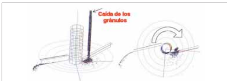
FIGURA 1.- SIMULACIÓN DEL MOVIMIENTO DE LOS GRÁNULOS SOBRE EL DISCO (VAN LIEDEKERKE, 2007)
