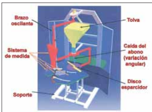
FIGURA 4.- PLATAFORMA MC2 PARA INVESTIGACIÓN APLICADA AL ESPARCIDO CENTRÍFUGO (MICLET)
