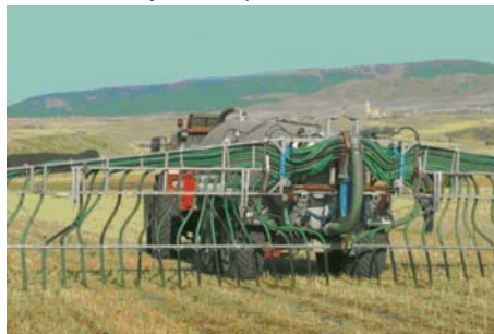
Figura 6. Sistema de aplicación de deyecciones líquidas mediante inyección superficial
