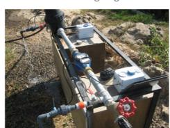
Esta norma es aplicable para verificar el grado de filtración declarado por el fabricante para un filtro específico, según el método CCM (Clogging Capacity Meter), comparando el grado de filtración del filtro ensayado con el grado de filtración de una malla filtrante estándar. Se trata por tanto de un método de campo, en el que se verifica el grado de filtración de un filtro específico con un agua determinada, no un método de ensayo para la determinación del grado de filtración.
