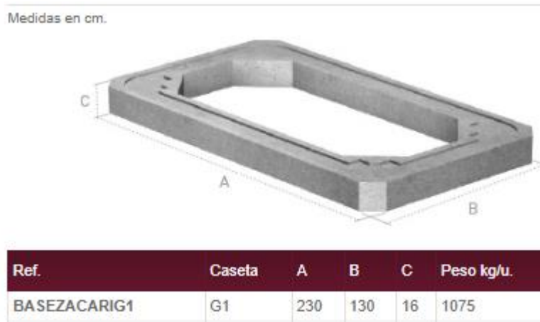
Ilustración 6 : Base caseta hidrante
