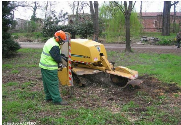
Máquina que arranca y tritura las raíces afectadas. El material se queda allí dado que se supone que alcanza altas temperaturas al
