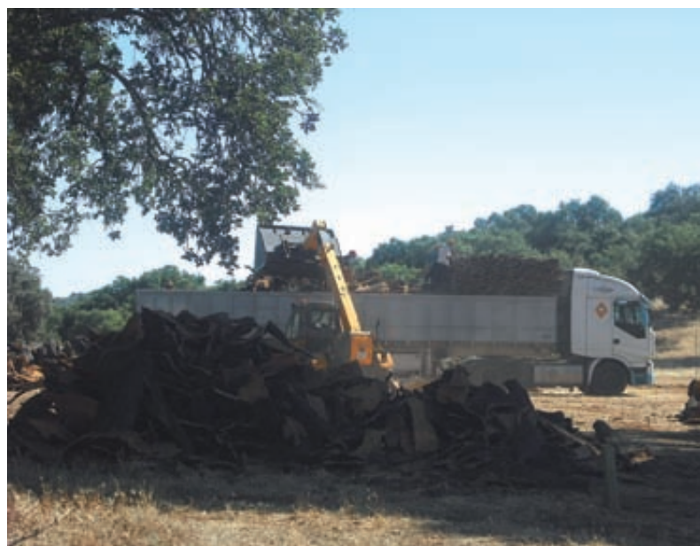
Foto 12. Carga de corcho en camión mediante manipuladora telescópica.
