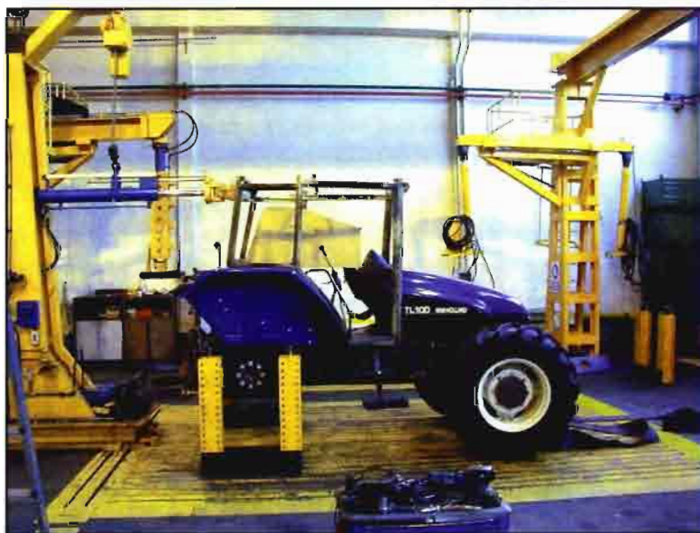
Aplicación del empuje trasero a una cabina de seguridad. Escuela de Mecánica Agrícola (Madrid).
