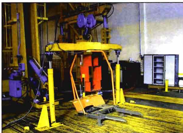
Aplicación de la viga de aplastamiento a una estructura de protección. Escuela de Mecánica Agrícola (Madrid).
