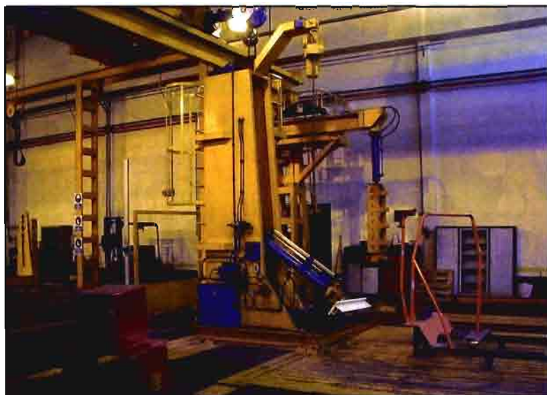
Vista general de la instalación de ensayo estático de estructuras de protección de la Escuela de Mecánica Agrícola (Madrid).
