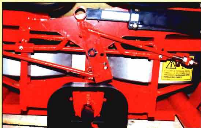
Imag. XI. Detalle dispositivo de Aguirre para abrir parcialmente el disco exterior al bordear y así completar deficiencias iniciales en el ancho de vía del tractor.
