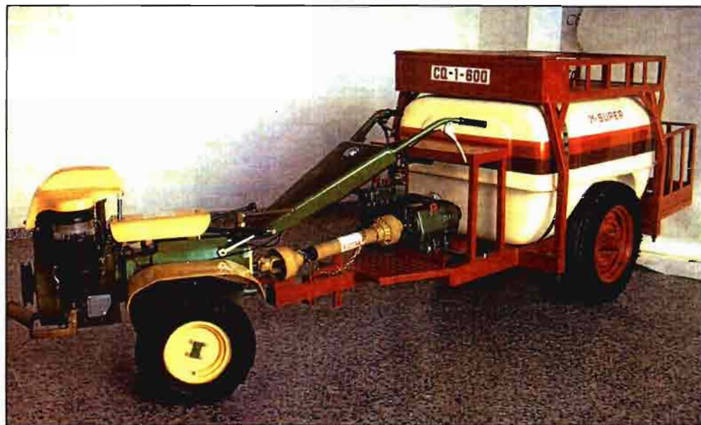
Acoplamiento de un equipo de pulverización a un motocultor con toma universal. Marca Llac.
