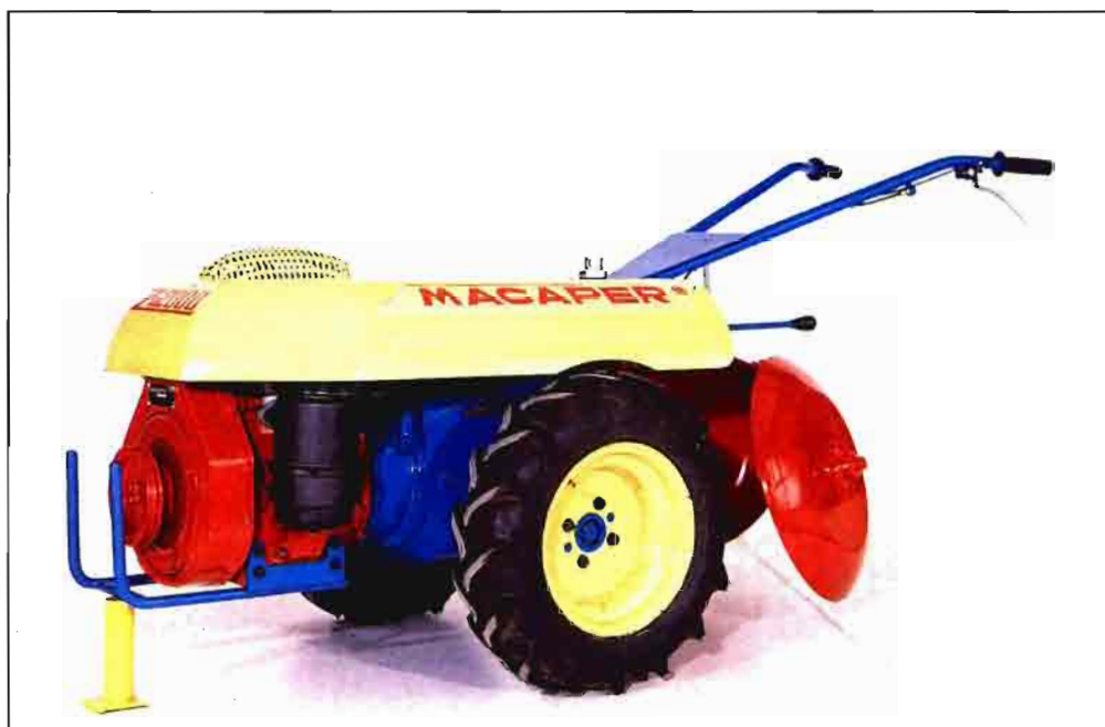
Motocultor es la máquina automotriz conducida a pie y destinada a accionar y/o arrastrar útiles de trabajo.
