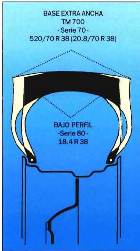
Fig. 3. Neumático de base extra-ancha que puede montarse en una llanta normal. (Doc. Pirelli).
