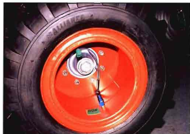
Fig. 6. Dispositivo de inflado de neumáticos desde el puesto de conducción del tractor.
