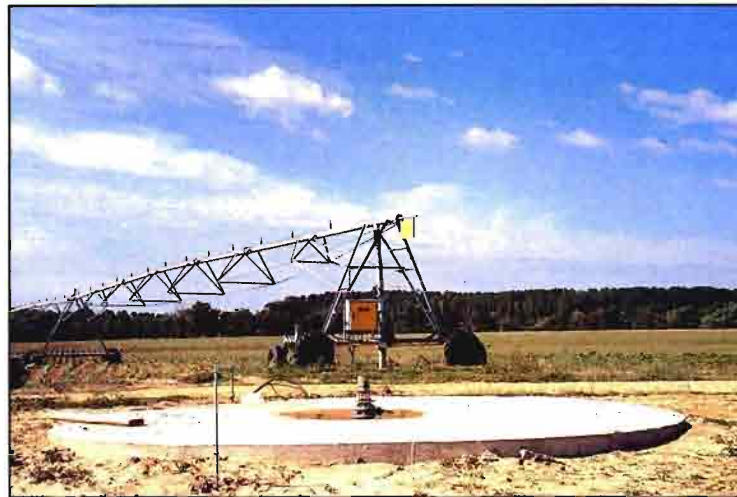
Plataforma de un pivot multicentro que riega 25 ha a cada lado del camino. Detalle de la curva de un pivot y el pico.
