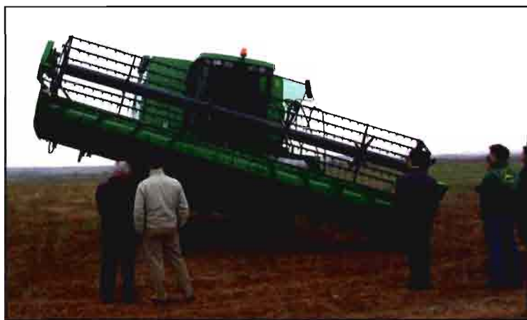
El sistema Hillmaster II permite cosechar en desniveles de hasta un 22%.
