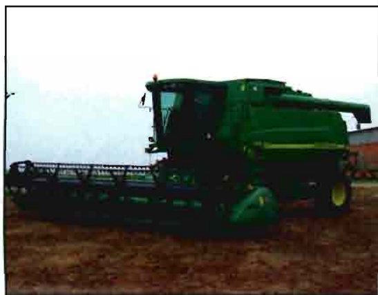
La 9780 CTS realiza la separación por cilindros de dedos.
