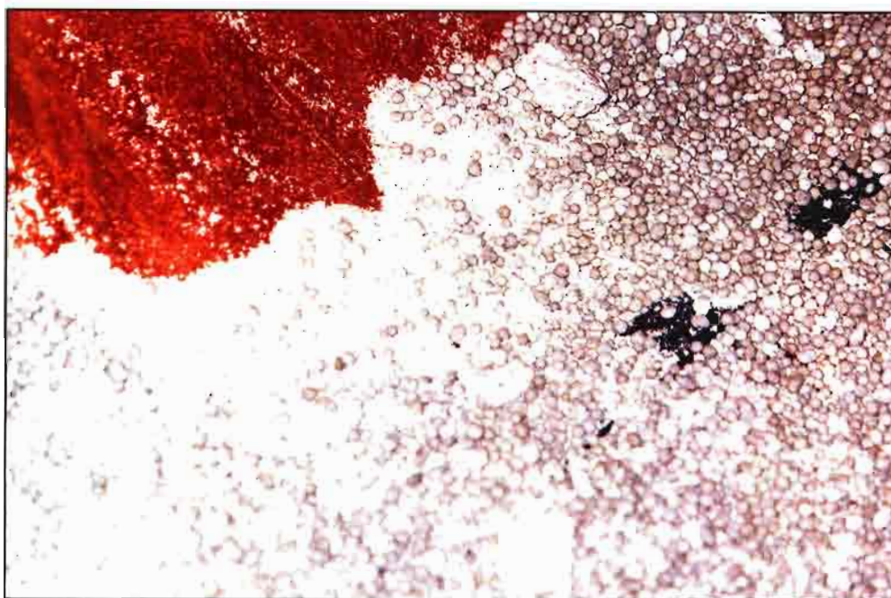
Fig 4. Detalle de abono con demasiado polvo para ser adecuado para la distribución con abonadoras de proyección.
