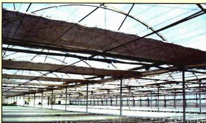
Fig. 8. Invernadero con pantallas térmicas aluminizadas.
