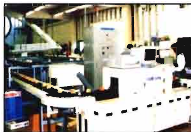
Sensor SMM láser montado en una pequeña línea de clasificación (Documentación Sumitomo).
