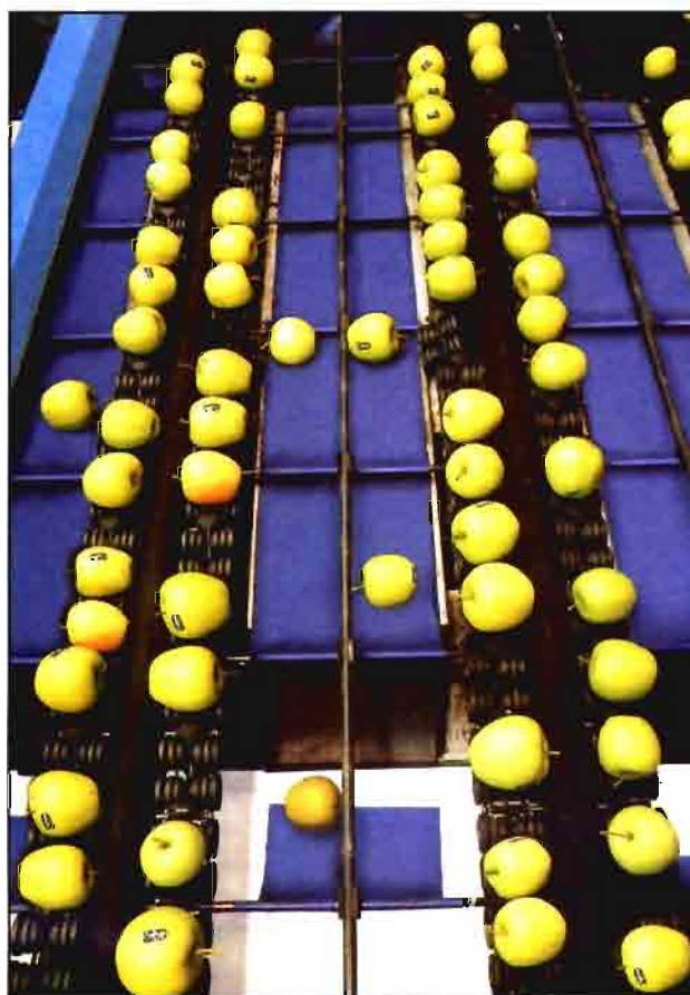
Figura 1. Cadena de calibración con fruta individualizada (Documentación Sammo).
