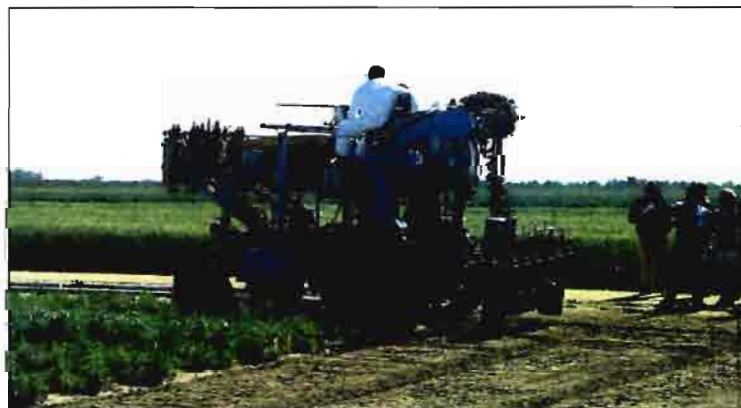
Aplicadora experimental de fitosanitarios en cultivos a pleno campo (arriba).
