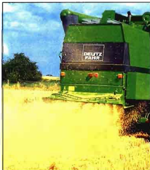
Figura 5. Mecanismo picador-esparcidor de paja montado en el extremo trasero de una cosechadora.
