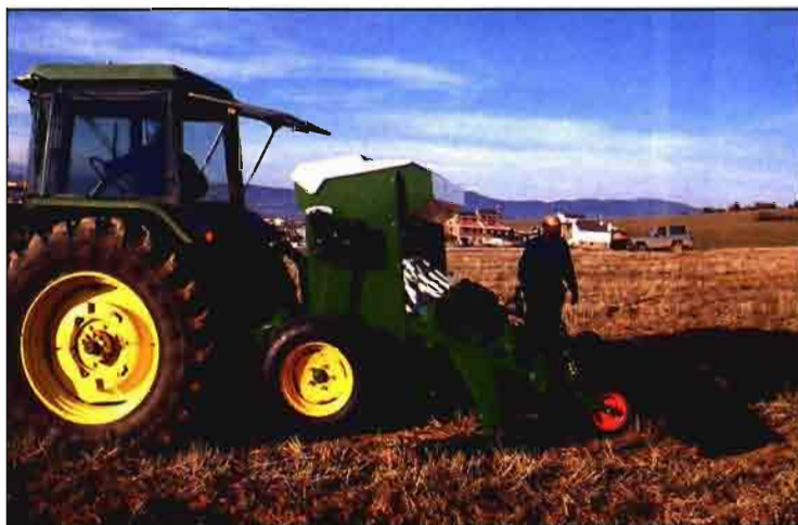
Sembradora de siembra directa para cereales GIL con sistema abresurcos de rejas en forma de «T» invertida.
