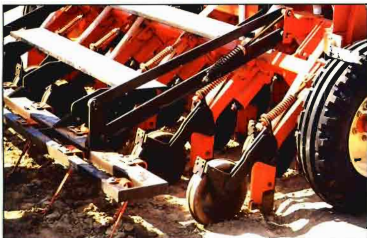
Sembradora de siembra directa para cereales SOLA con siembra abresurcos de rejas «punta de flecha».
