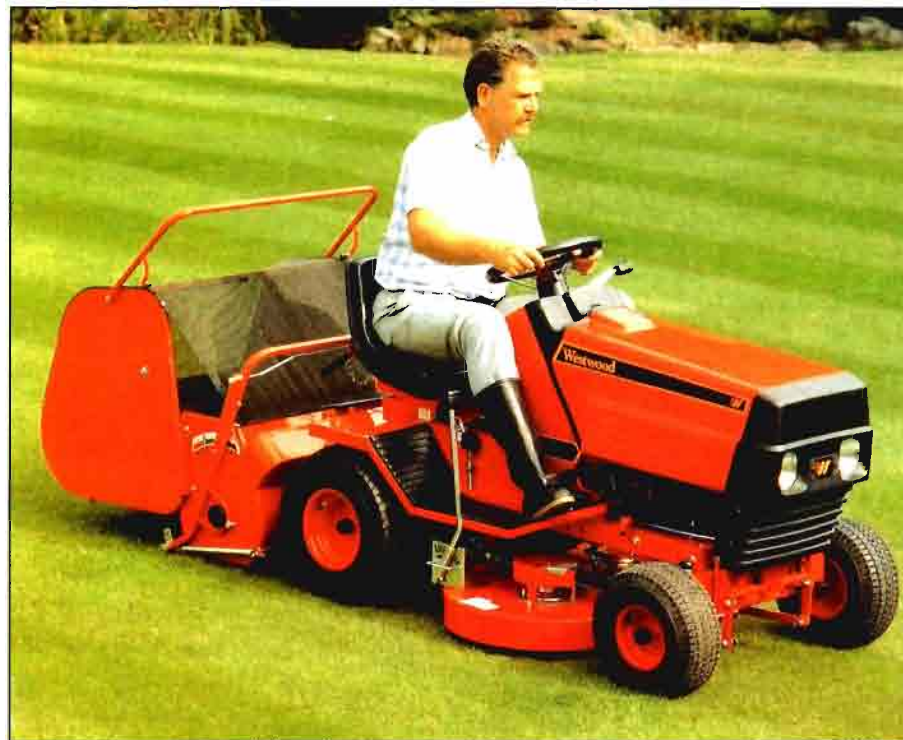
Cortacésped de eje vertical con asiento y sistema de recogida lateral.
