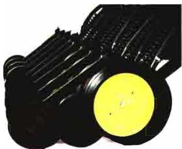
La acción combinada del abresurcos, la rueda de profundidad, la rueda de presión y la rueda de cobertura proporcionan un contacto óptimo entre la tierra y la semilla, incluso en siembra directa sobre rastrojo.
