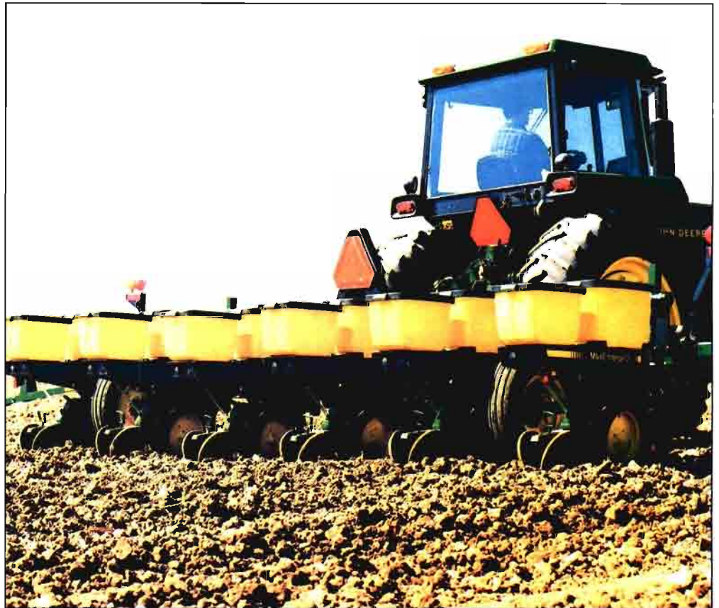
Sembradora Max-Emerge John Deere, con sistema exclusivo de dosificación de semillas.
