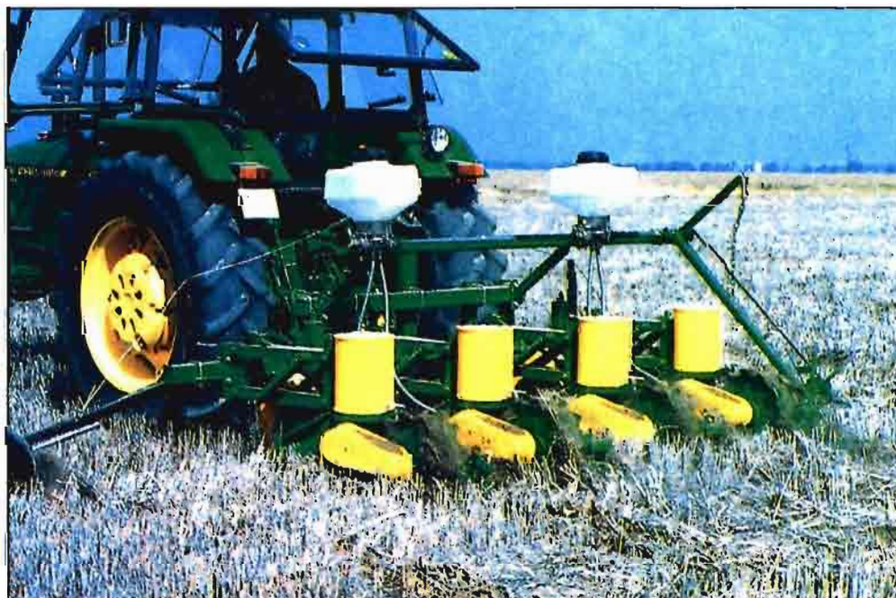
Sembradora Gil con abresurco mixto en disco o reja para siembra directa.
