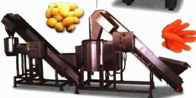
Línea monobloque de pelado y corte de patatas y zanahoria
