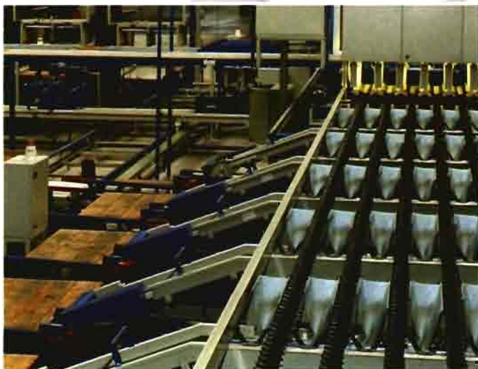
Máquina de "cadenas inteligentes" para calibrar por color, diámetro, volumen, peso y calidad.
