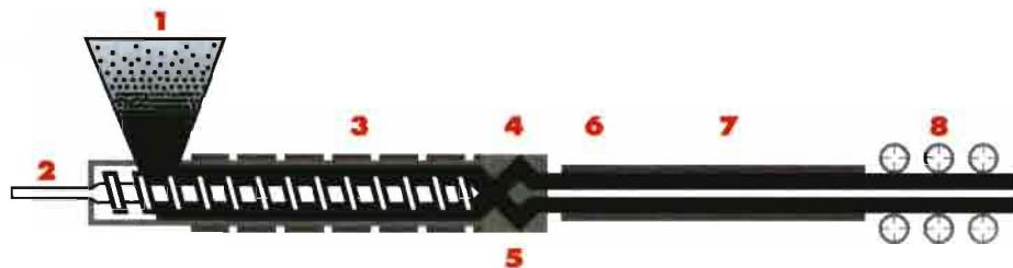
Fabricación de tuberías de riego y de drenaje. 1- Tolva. 2- Tornillo de extrusión. 3- Calentamiento eléctrico. 4- Cabezal. 5- Torpedo. 6- Conformador de la tubería. 7- Enfriamiento. 8- Rodillos.
