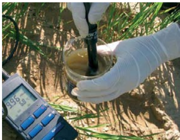
Foto 2. Conductímetro manual de campo con el que se está realizando una lectura de la CE de un purín.
