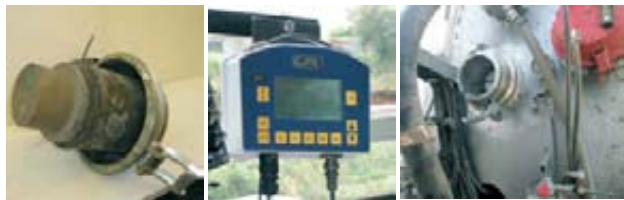
Foto 3. Imágenes de la sonda y el monitor del equipo Fertimeter (conductímetro automático) y de la sonda instalada en la cisterna para realizar las lecturas de conductividad del purín.
