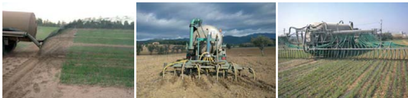
Foto 4. Distintos tipos de aplicadores de purines. De izda. a dcha: abanico; enterradores/inyectores, y rampas con tubos colgantes.
