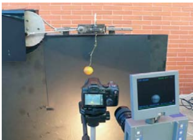
Sacudidor de laboratorio con fruto aislado utilizado en los ensayos.
