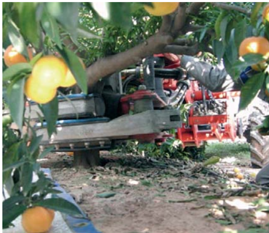
Vibrador de troncos usado para la recolección de cítricos.
