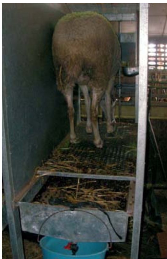
Celdas metabólicas para la alimentación y recogida de deyecciones sólidas y líquidas (Instituto de Ciencia y Tecnología Animal, UPV.)
