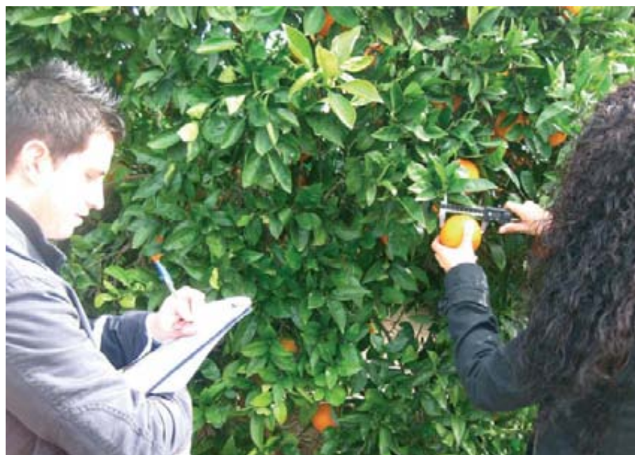
Fotos 1 y 2. Detalle del empleo en campo del calibre digital y del dinamómetro adaptado.
