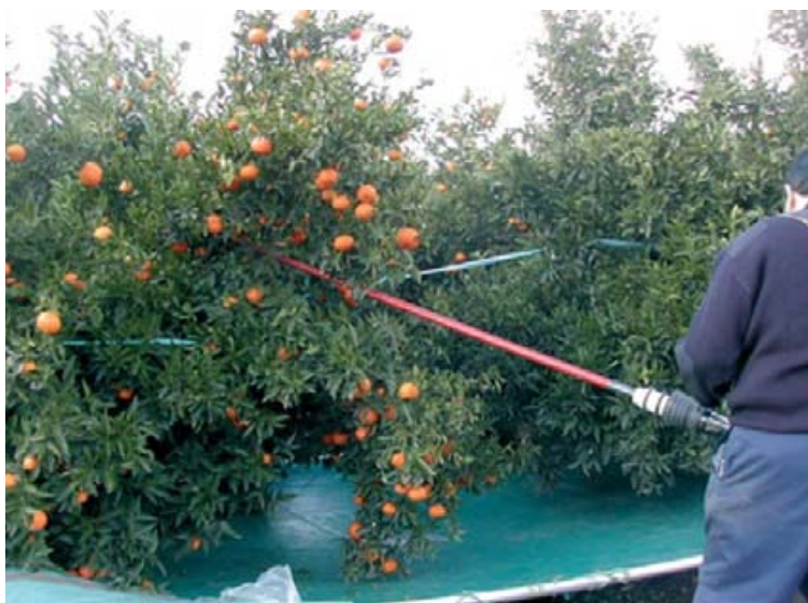
Foto 2. Vibrador de ramas de gasolina en una rama de naranjo.
