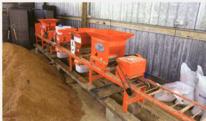
Foto 2. Tren de siembra de bandejas: 1) tolva para la aplicación del sustrato base en la bandeja, 2) sistema para la aplicación de agua + fungicida + producto enraizante, 3) sistema distribuidor de la semilla de arroz, 4) sistema para la aplicación de la capa superior de sustrato y 5) sustrato de siembra.
