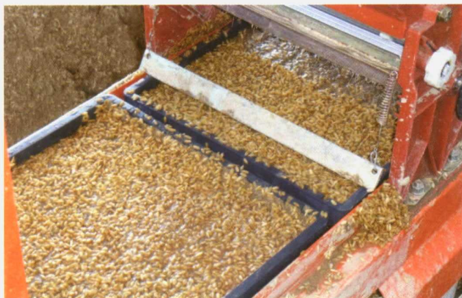
Foto 3. Distribución del arroz en las bandejas realizado en el tren de siembra mecanizado.
