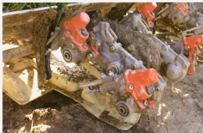
Foto 10. Cabezal de trasplante equipado con dos pinzas.
