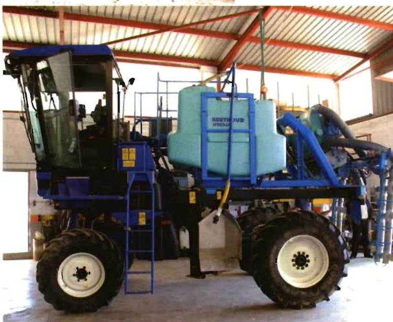
Abajo: Una vista del taller con la segunda vendimiadora en la que están instalando el kit de pulverización neumática Berthoud.
