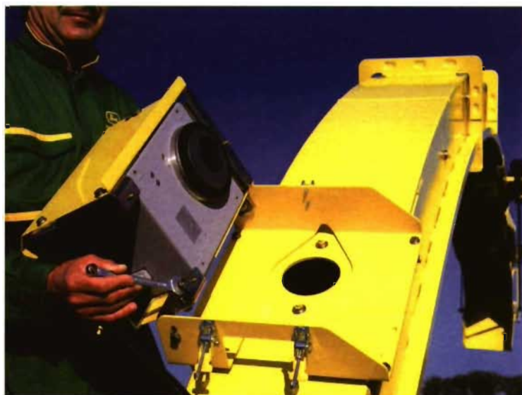
Hay sensores que determinan la humedad del producto, para descontarla y calcular la producción referida a materia seca.
