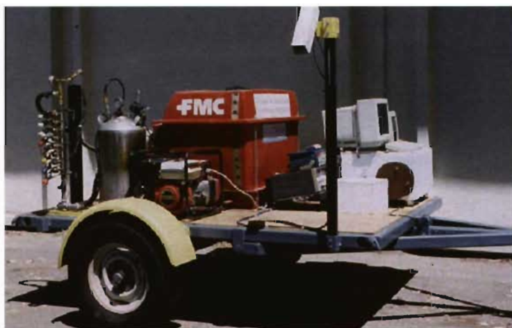
Foto 6. Prototipo inicial del sistema Inteligente de aplicación.
