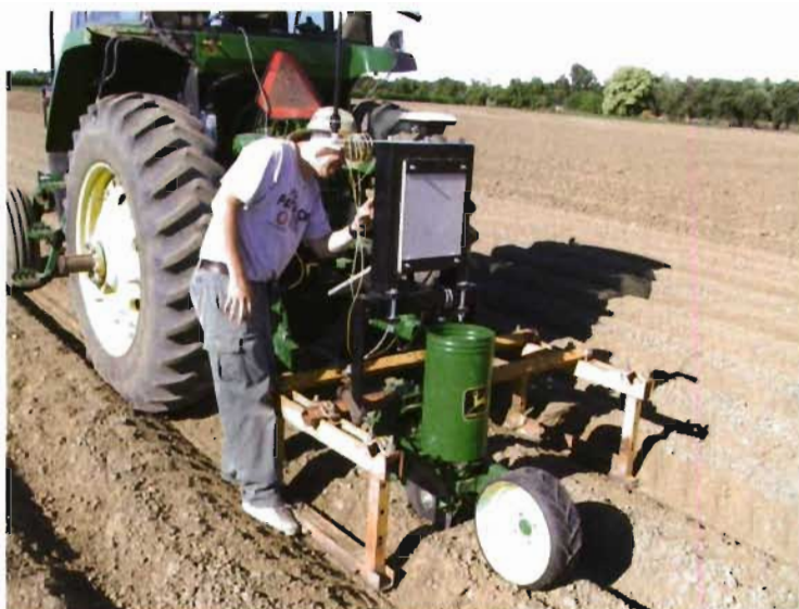
Foto 7. Sembradora usada para la obtención de los mapas de semillas.
