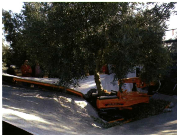
Detalle de vibrador con paraguas invertido.
