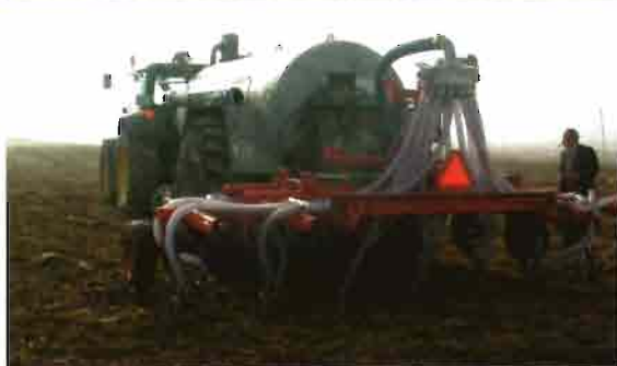
Arriba, tanque de purín con sistema de enterrado para praderas.
