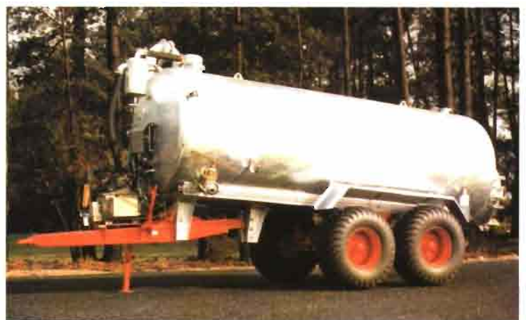
Tanque distribuidor de purín con lanza amortiguada y eje doble.
