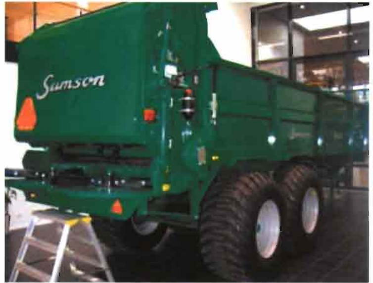
Remolque esparcidor de estiércol de descarga trasera con mesa de esparcido de rotores verticales.
