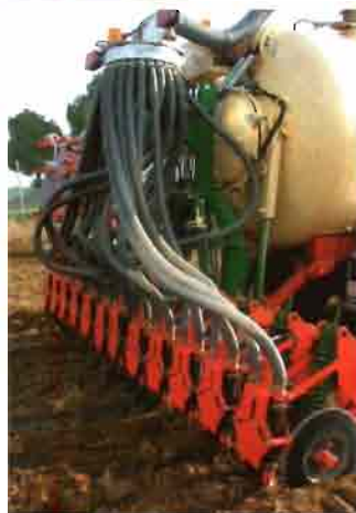
Arriba, tanque de purín con sistema de enterrado para praderas.
