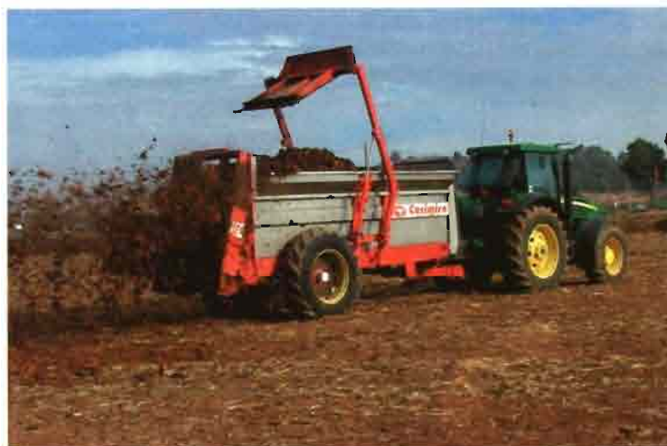
Remolque esparcidor de estiércol de descarga trasera con rotores verticales.
