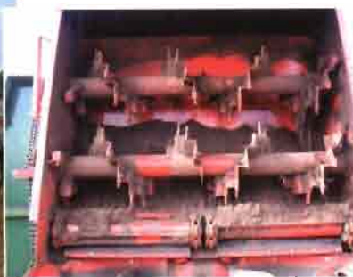
Remolque esparcidor de estiércol de descarga trasera con rotores horizontales.
