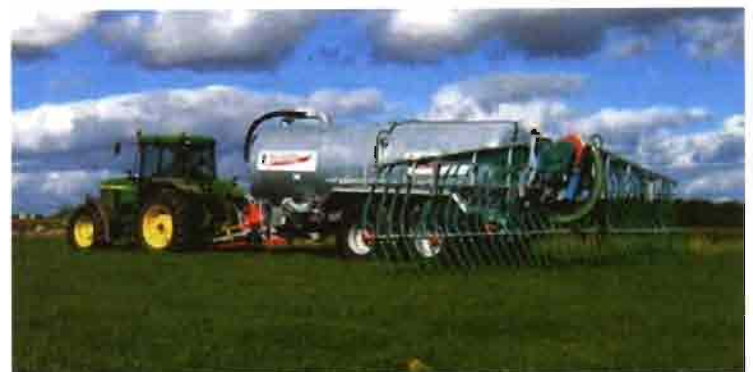
Tanque de purín con sistema de distribución de barra con tubos colgantes.
