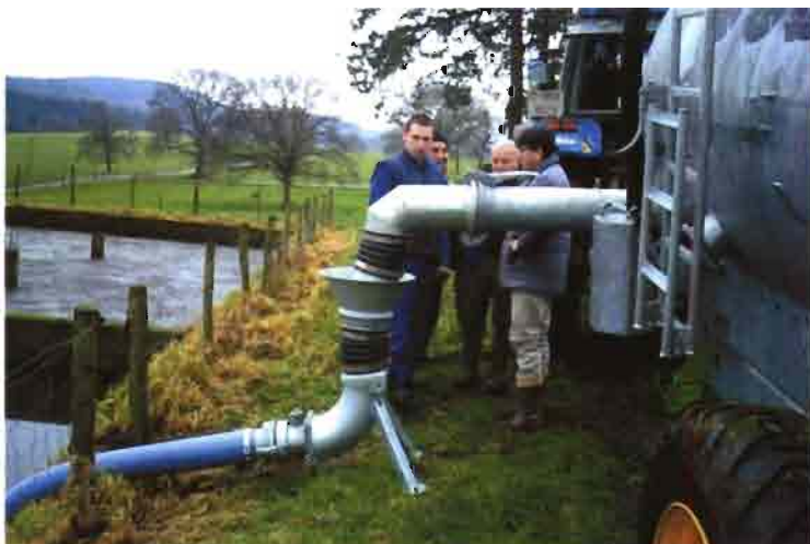
Brazo de carga lateral con embocadura fija a pie de fosa.
