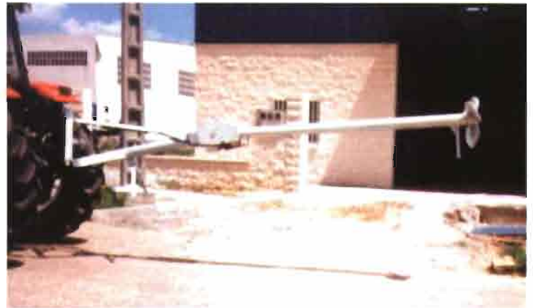
Agitador mecánico helicoidal de purín.
