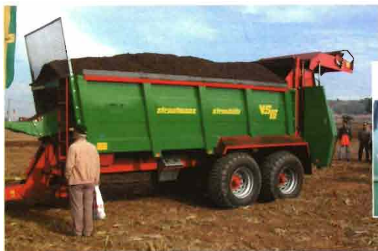
Remolque esparcidor de estiércol de descarga trasera con rotores horizontales.
