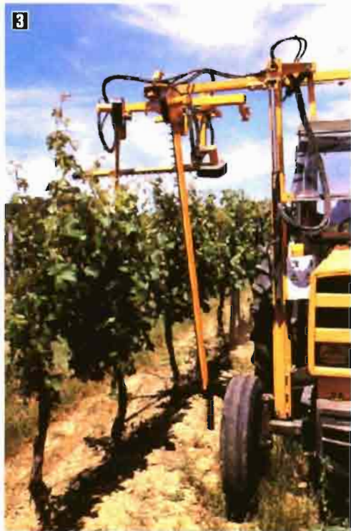
Foto 3. Despuntadora con barra de corte con movimiento alternativo dispuesta en "U" invertida.
