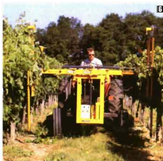
Foto 6. Despuntadora con barras de corte verticales laterales.
