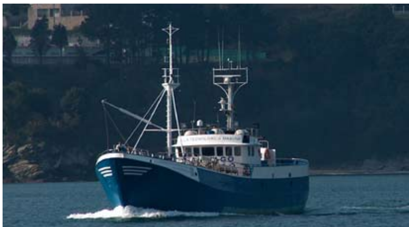
El "Santiago Apóstol" cedido para su uso en este proyecto por la Cofradía de Pescadores de Celeiro, es un buque palangrero, de 33m de eslora, con una antigüedad de 35 años, dotado de un motor diesel de 600CV.
