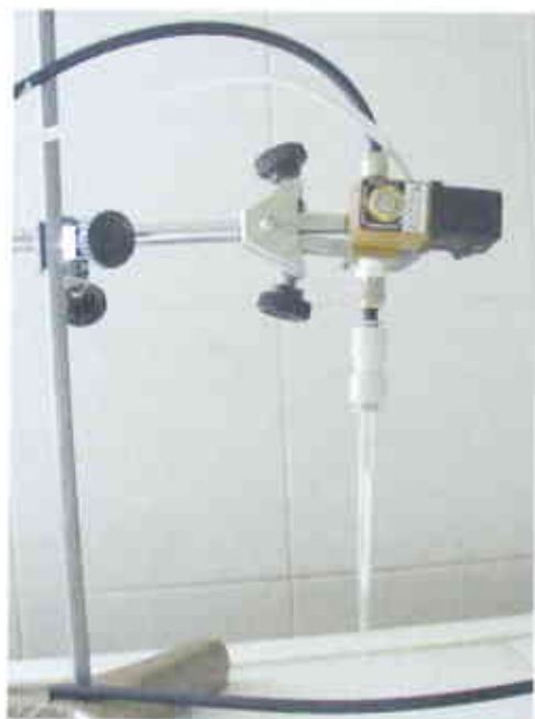
Figura 3. Electroválvula conectada a pipeta Pasteur.
