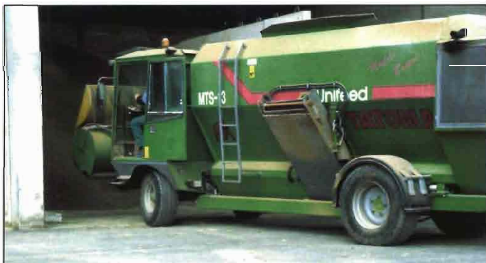
El proceso comienza con la mezcla de los componentes en una máquina autopropulsada.
