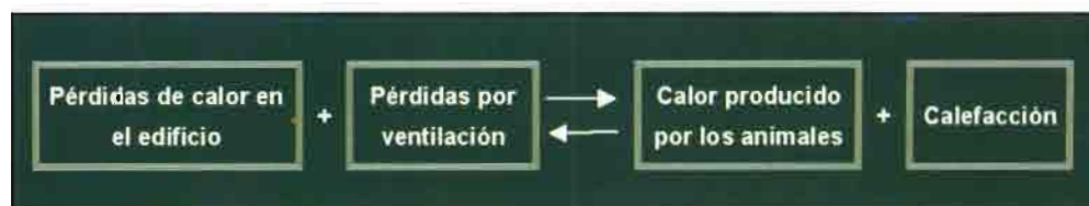
Figura 1.-Balance térmico en un alojamiento.
