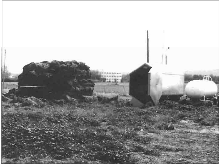
Tanque y horno para el tratamiento de paja de cereal con amoníaco y restos de almiar de paja tratada.
