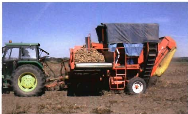
Arriba cosechadora de patatas con tolva o integral, a la izquierda elementos de arranque y a la derecha tamizado de tierra en la cadena primaria.
