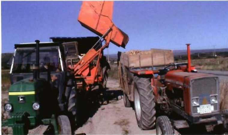
A la izquierda descarga de la tolva a remolque por volteo hidráulico y a la derecha descarga de la tolva a "big bag" con fondo móvil.
