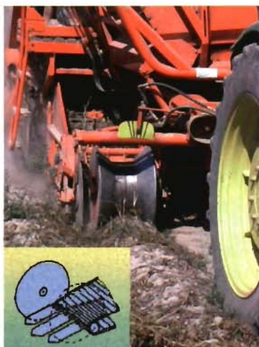
Arriba cosechadora de patatas con tolva o integral, a la izquierda elementos de arranque y a la derecha tamizado de tierra en la cadena primaria.
