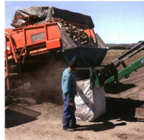
A la izquierda descarga de la tolva a remolque por volteo hidráulico y a la derecha descarga de la tolva a "big bag" con fondo móvil.
