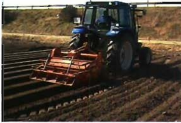
A la izquierda rotocultor acaballador y a la derecha pulverizador hidráulico con asistencia por aire.
