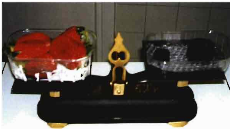
Balanza mecánica para el control manual de peso en fresa.
