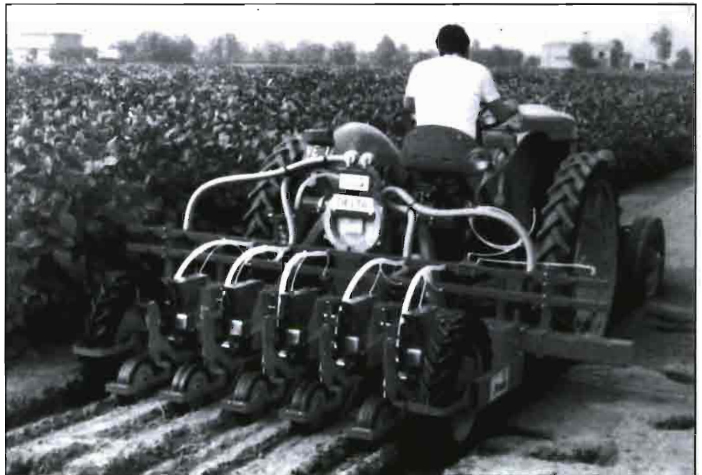
Al lado, sembradora neumática con cinco líneas.
