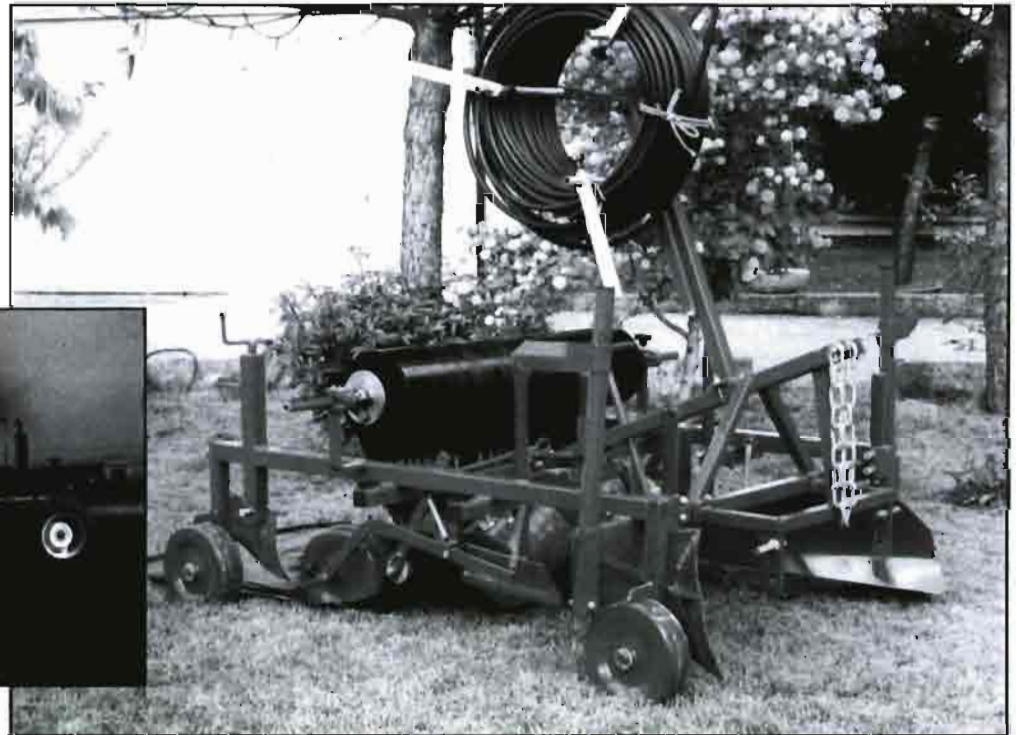
En la imagen inferior, nivelación de parcela por medio de láser. Al lado, conformadora, extendedora de plástico y distribuidora de tubería de riego.
