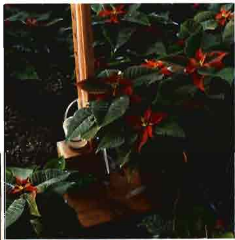
Detalle de un tensiómetro para control de riego en Poinsettia. Debajo, tensiómetros en ensayo de sustratos sobre cyclamen. Se coloca un tensiómetro por sustrato.
