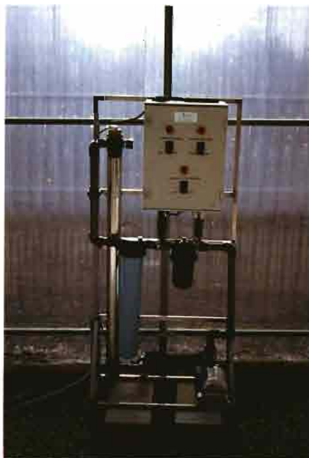
Prototipo de la unidad de desinfección por U.V. diseñada por la empresa INKOA Sistemas.
