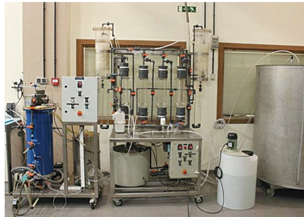
FIGURA 1. Digestor anaerobio con gasómetro y planta de tratamiento de biogás
