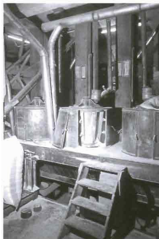
Molino para descascarillar el arroz y pulirlo si se desea blanco
