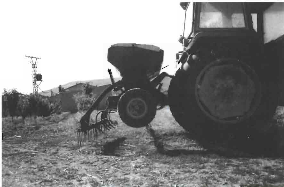
Personalización de una sembradora convencional para cultivo en ecológico
