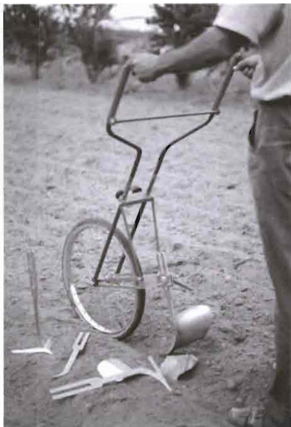
El kit de cuatro herramientas: reja, arado, surcador y escardador.
