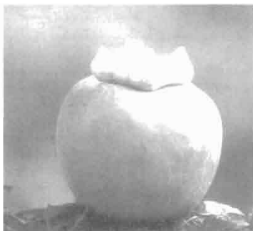
Ha ideado una forma de hacer recipientes con arcilla que sólo necesita 70 °C de temperatura, fáciles de conseguir en una cocina- horno solar, sin consumo energético. Una vez precalentados, se bañan en cera fundida en otro horno solar. La cera llena los poros de la arcilla de manera que queda una pieza muy sólida, elástica, que no se agrietará, con un tacto muy agradable.
